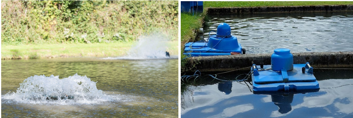
Abbildung 10: Sauerstoffeintrag mit (1) Oberflächenbelüftern und (2) Niederdruckbegasern (Foto 1: Fischkultur NRW; Foto 2: Cornelius Becke, LANUV)
