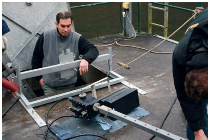
Abb. 3: Einbau des DIDSON in den Turbinenschacht (rechts) und EDV-gestützte Aufzeichnung der Ergebnisse (links).
